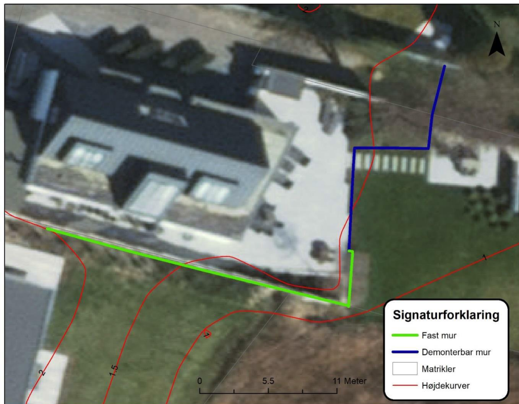
Fig. 5.13. Oversigt over linjeføring af fast mur og demonterbar mur
